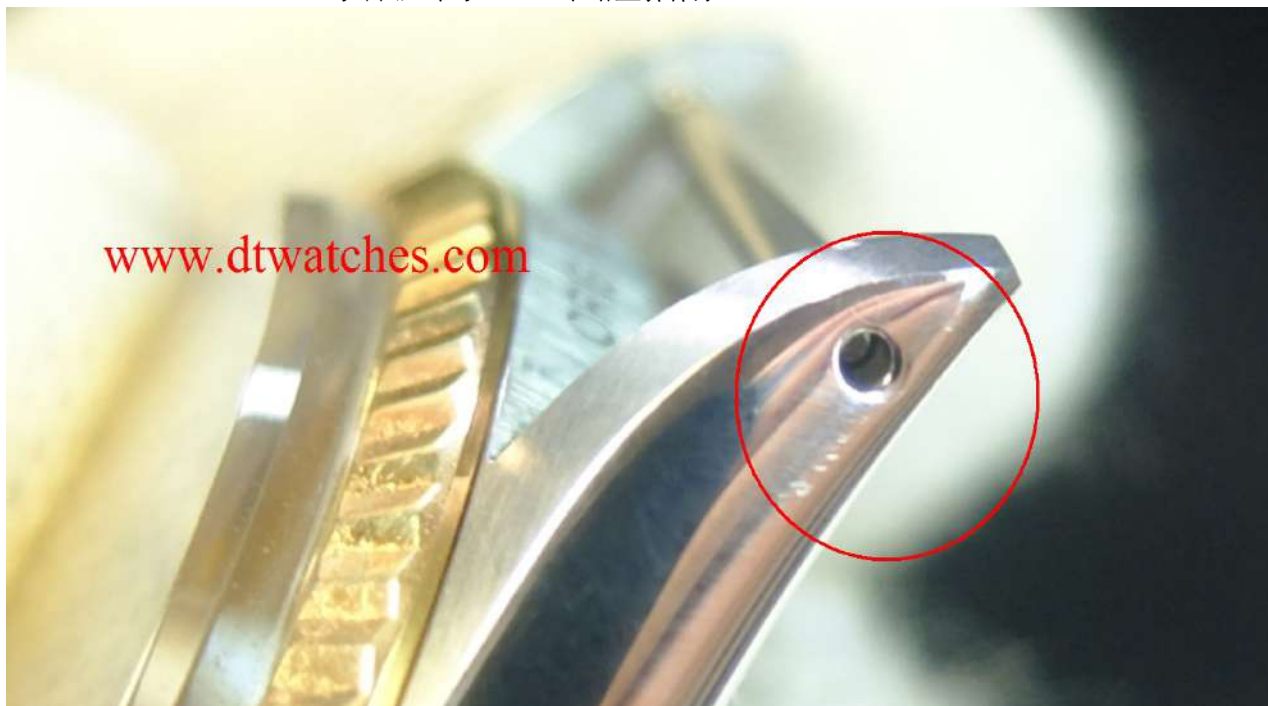
圖26(即圖24) 錶孔邊緣有向外傾倒狀況,外觀形成漏斗形
